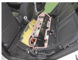
6. Retirer la fixation de la garniture de protection de la portière arrière (A).
