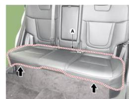
3. Mettre le bouton du contact sur OFF et déconnecter le connecteur positif (+) de la batterie auxiliaire 12V (A).
